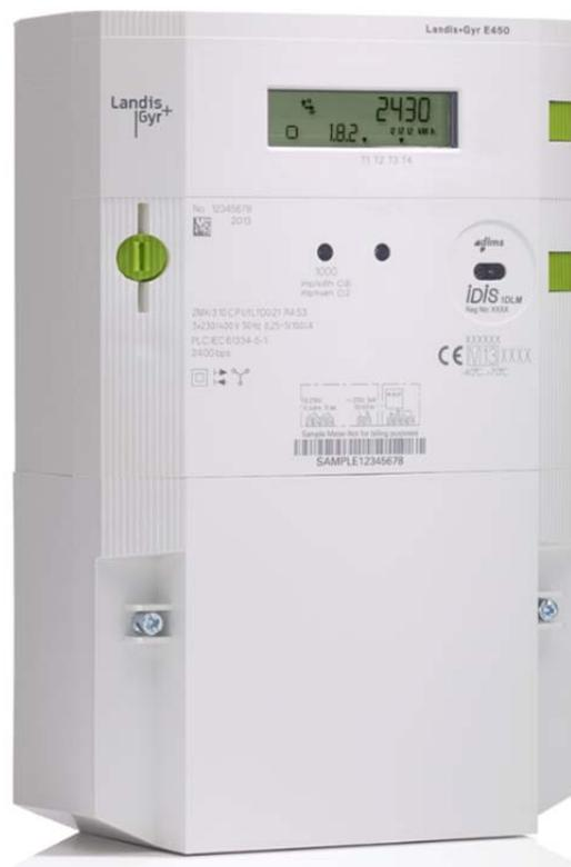
Der E450 Serie 4 IDIS G3-PLC OFDM ist ein moderner, integrierter Haushaltszähler mit Kernfunktionen wie beispielsweise leistungsfähigem E-Metering, Multi-Energie-Datenerfassung, Fern- und Lokalkommunikation, sowie Interaktionsmöglichkeit mit dem Endbenutzer. Der E450 Serie 4 IDIS basiert auf offenen und voll kompatiblen Standards. Die G3-PLC OFDM-Technologie für Hochgeschwindigkeitskommunikation gestattet eine einfache Integration in AMM-Systeme.
